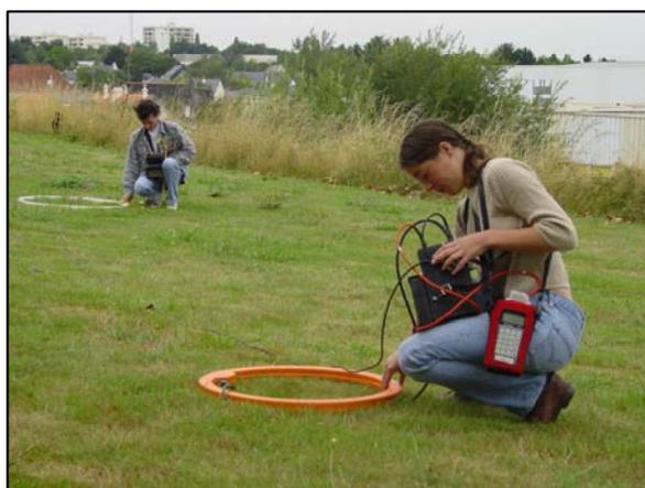
Mesure EM34 : Equidistance 10 m, mode dipôle vertical
