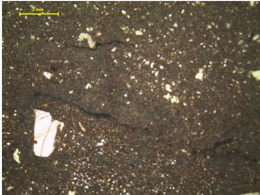
A : Basalte en lumière naturelle : gros cristaux d'olivine dans une pâte constituée de microlites de feldspaths alcalins (albite)
