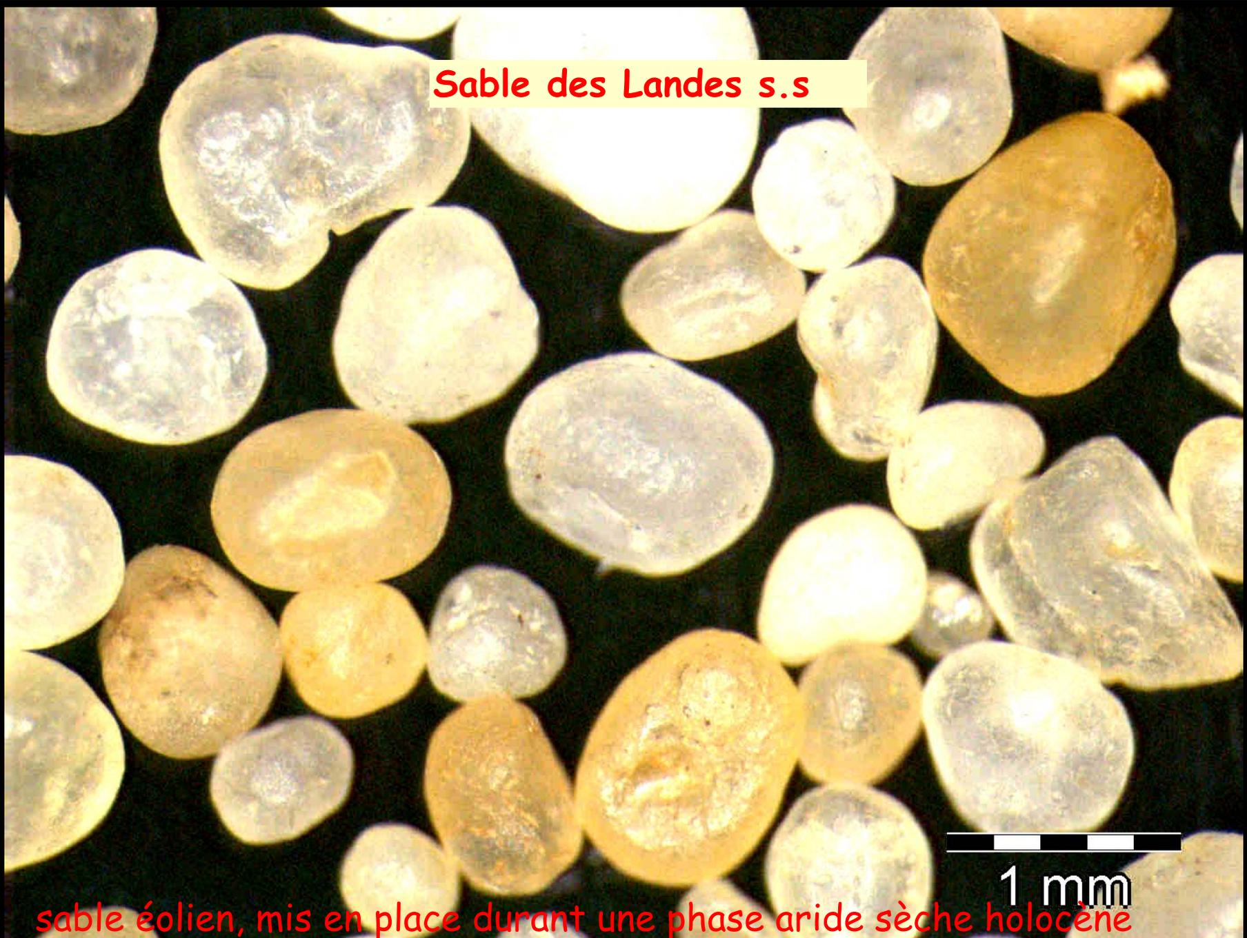
sable éolien, mis en place durant une phase aride sèche holocène
